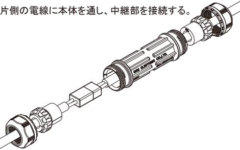
4. 締付キャップを締め、電線を固定する。
