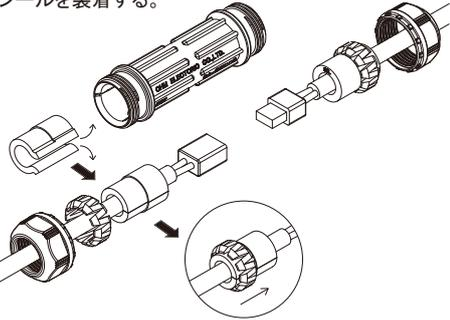
3. 片側の電線に本体を通し、中継部を接続する。
