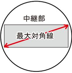
中継部の最大対角線寸法が外形寸法図の内部スペース以下である事。
