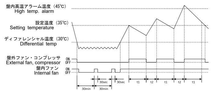
※盤外ファン・コンプレッサ間欠運転時の冷却運転時間(7分) \* Operation time of internal fan and compressor during intermittent operation (7 min.) ※盤外ファン・コンプレッサの停止時間(3分) \* Shutdown time of external fan and compressor (3 min.)
