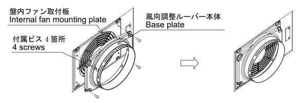
②風向に角度を付けたい場合は、風向調整ルーバー本体に先端部を取付け、先端部を回転させ 風向きを調整してください。先端部の羽根角度は約25°です。また、先端部の回転は45°間隔で ロックが掛かるようになっています。先端部の向きによってはショートサーキット(P.7)が 発生する可能性がありますので、注意してください。風向調整ルーバー本体と先端部の取付により、 盤内ファン取付板面より盤内へ70mm突出します。
