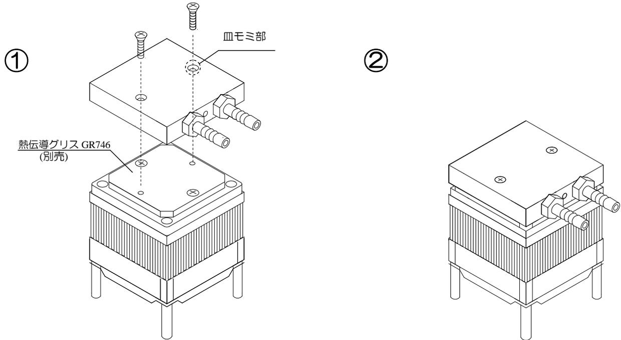
水冷ジャケットをネジで固定して下さい。
